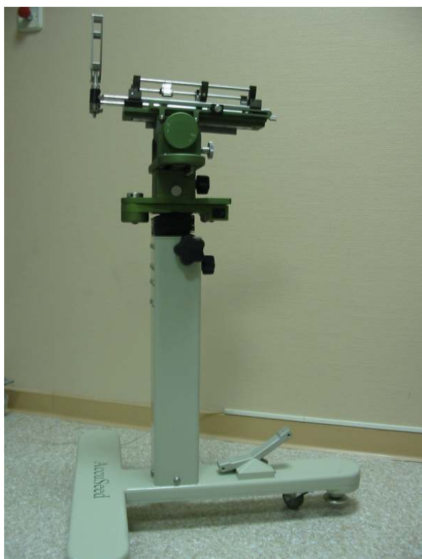
FIGURA 5. Sistema de fijación del ecógrafo
